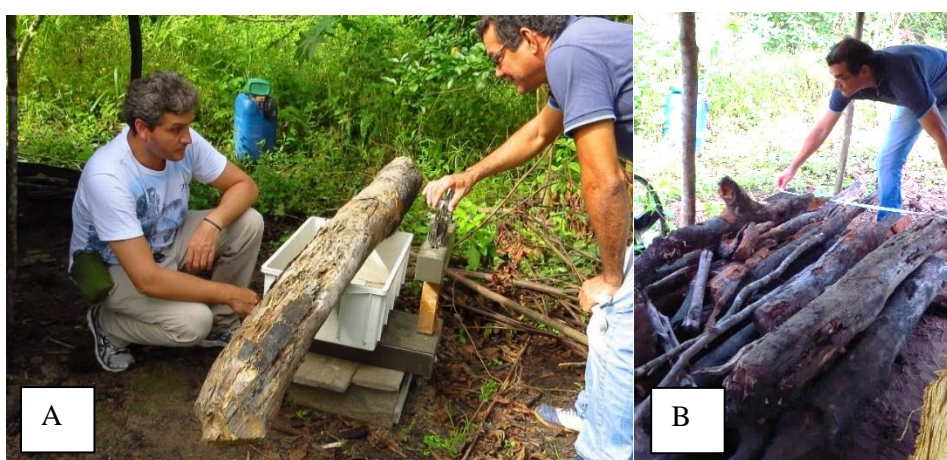
Figura 2: Quantificação da lenha utilizada pelo agricultor para cada farinhada no município Igarapé-Açu, nordeste do Pará. A- Pesagem da lenha (kg), B- Medição (st) da pilha de lenha do agricultor.
