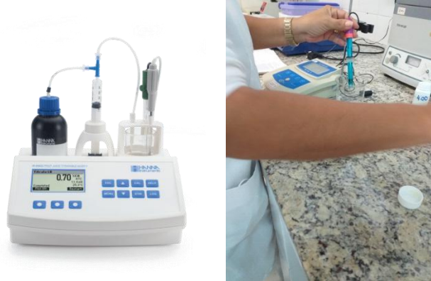
Figura 16- Determinação de pH com eletrodo.
