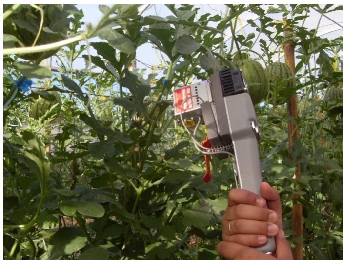
Figura 7. Avaliações fotossintéticas utilizando analisador de gás infravermelho (IRGA) portátil. UNESP-FCAV, Jaboticabal, 2016.
