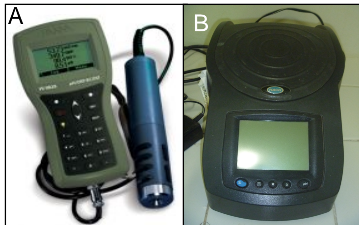
Figura 3: (A) Sonda da marca Hanna; (B) equipamento da marca Hach (DR 2500) para a medição de material em suspensão.
