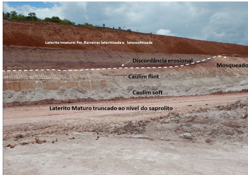
Figura 1. Perfil da seção longitudinal do caulim da região do Rio Capim, PPSA, Amazônia oriental, Brasil.
