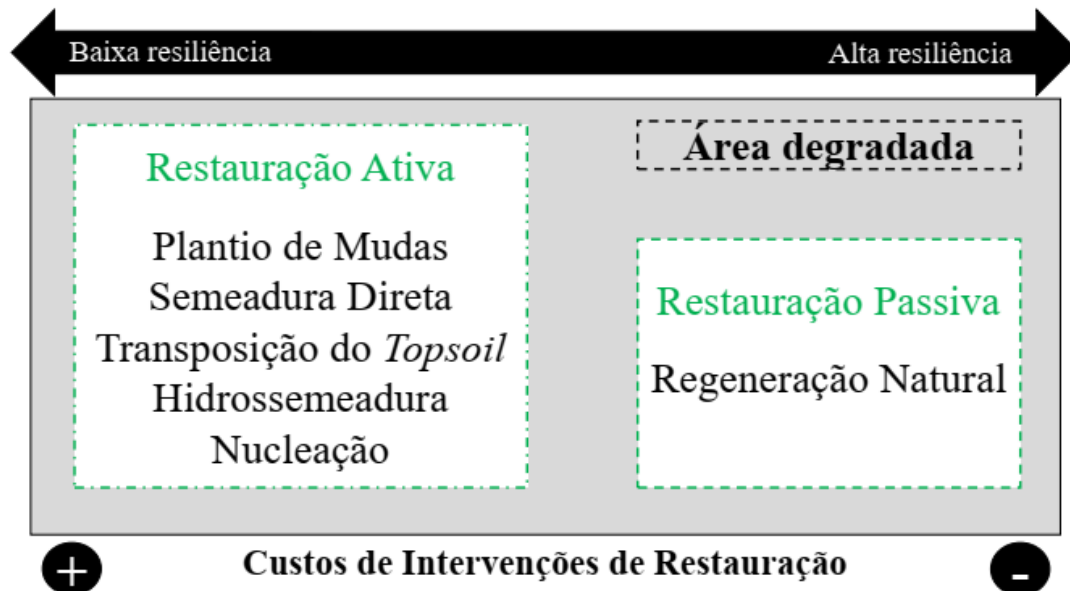
Figura 3. Principais métodos utilizados na restauração em áreas degradadas pós-mineração em função da resiliência local.
