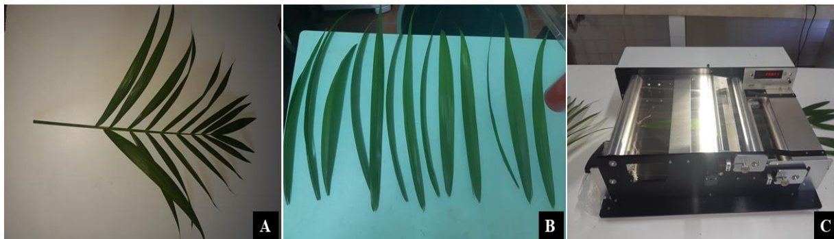
Figura 3 - Coleta de dados das folhas de açaí ( Euterpe oleracea Martius), cultivar BRS-Pará: A) Folha composta de açaí destacada; B) Folíolos destacados; e C) Integrador de área foliar (modelo LI 3100, Li-Cor Biosciences®, Lincoln Nebraska, Estados Unidos).
