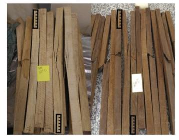
**Figure 3.** Image of the specimens after the mechanical testing, highlighted by the black ruler icons where the material was removed for the physical tests. **Figura 3.** Imagem das amostras após o teste mecânico, destacada pelos ícones da régua preta o material que foi removido para os testes físicos.
