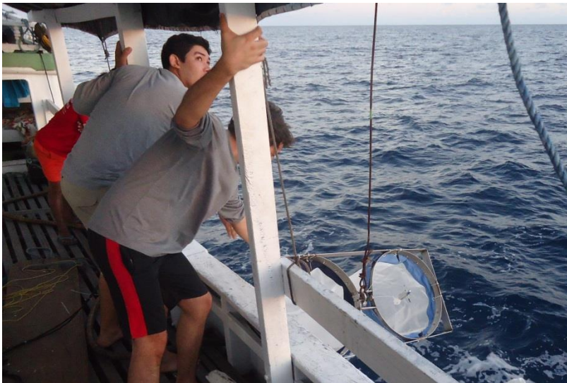
Figura 4 – Lançamento da Rede de plâncton do tipo Bongo.
