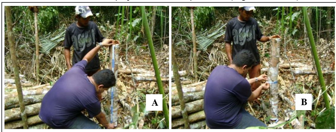
Figura 7. Medição de uma peça de resíduo florestal: A: medição do comprimento e B: medição da circunferência
