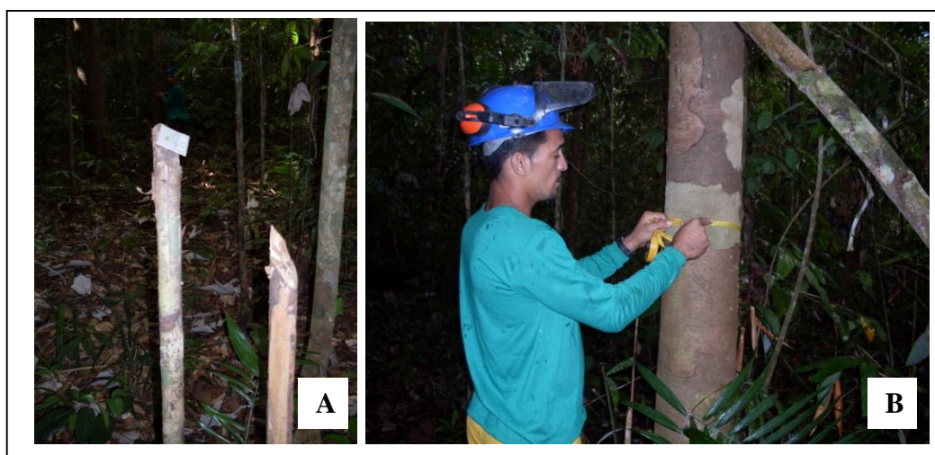
Figura 9. (A) Marco da picada e (B) Medição da circunferência da árvore com 10\text{cm} \leq DAP \leq 30\text{cm} .
