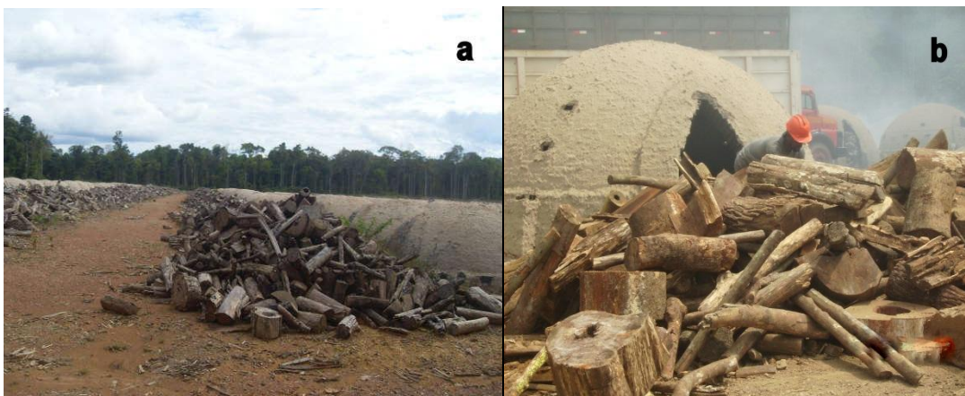
Figura 11 - Visão geral da Praça de carbonização com fornos de alvenaria do tipo rabo quente (a). Enchimento dos fornos com o resíduo de exploração florestal (b).
