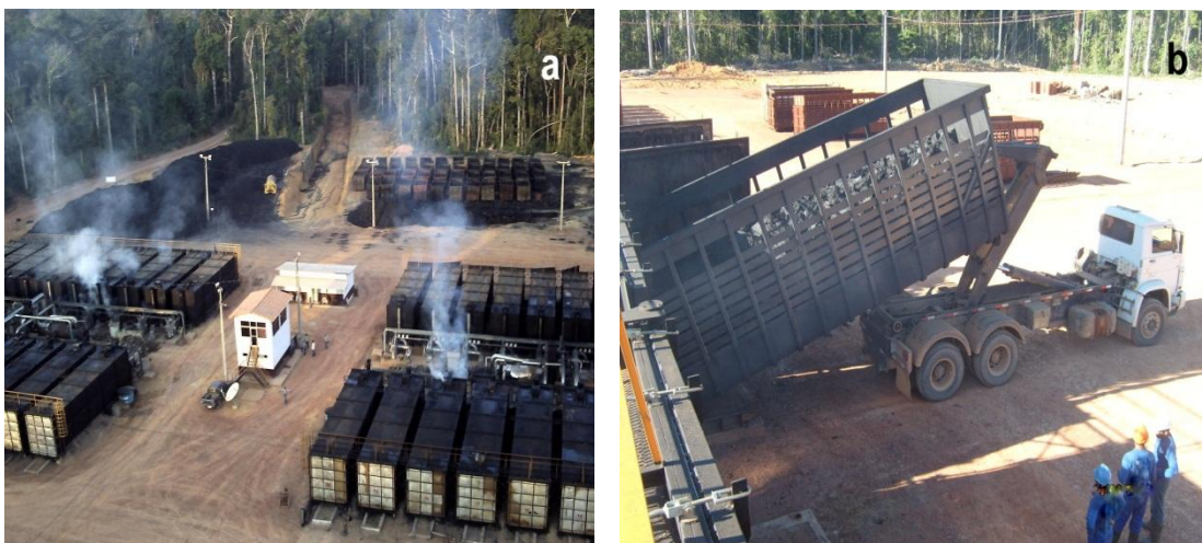
Figura 3 - Visão panorâmica da Praça de Carbonização com fornos metálicos (a); Detalhe do descarregamento do reator após a carbonização (b).
