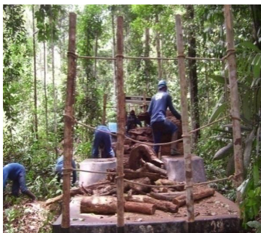
Figura 27 - Atividade de carregamento manual do reboque.
