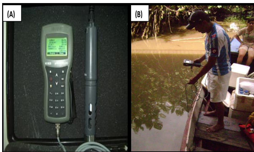
Figura 4.5: (A) Sonda Multiparâmetro Hanna HI769828; (B) Momento da medição “ in loco ”.
