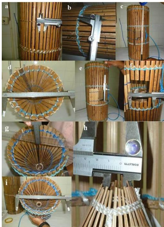
Figura 1: Detalhe do dimensionamento do matapi: cilindro - a) largura das talas (LTci); b) espaçamento entre as talas (ETci); c) altura do cilindro (Hci); d) diâmetro da base (Dci); e) altura da porta do cilindro (Hp) e f) largura da “porta ou boca” (Lp). Tronco de cone - g) altura do tronco de cone (Htc); h) diâmetro da base menor (dtc) e i) diâmetro da base maior (Dtc).
