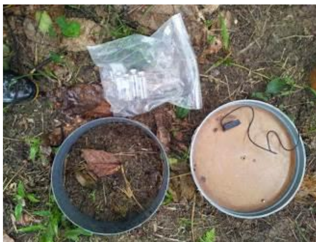
Figura 1. Câmara estática de geometria circular com seus respectivos compartimentos base e tampa
