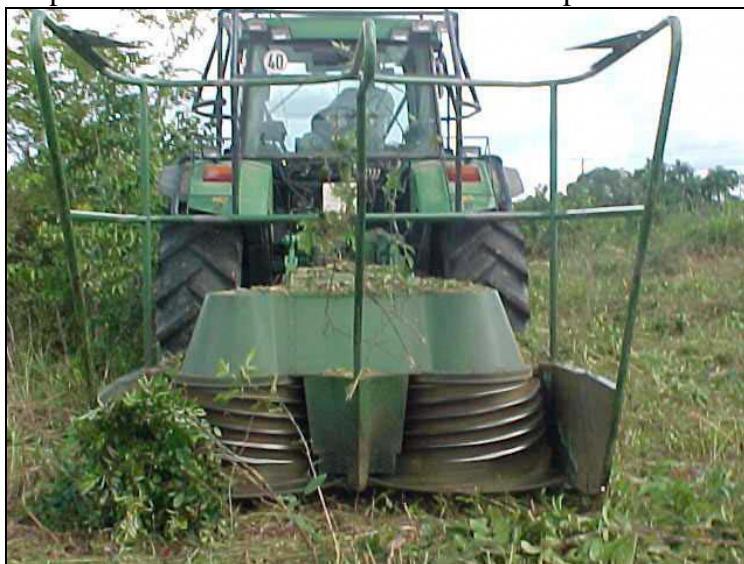
Figura 6- Protótipo do triturador de capoeira (Tritucap) acoplado a um trator de rodas de 70 kW de potência.
