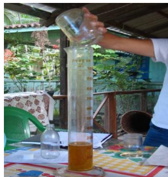
Figura 28 - Aferimento da quantidade de óleo extraído de sementes de várzea, através de proveta graduada.
