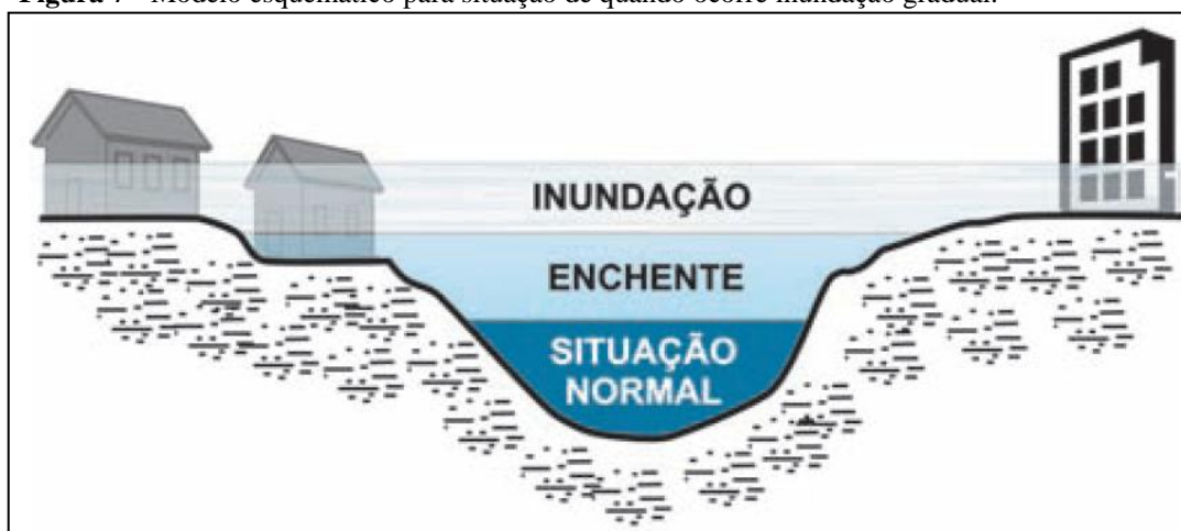
Figura 7 - Modelo esquemático para situação de quando ocorre inundação gradual.
