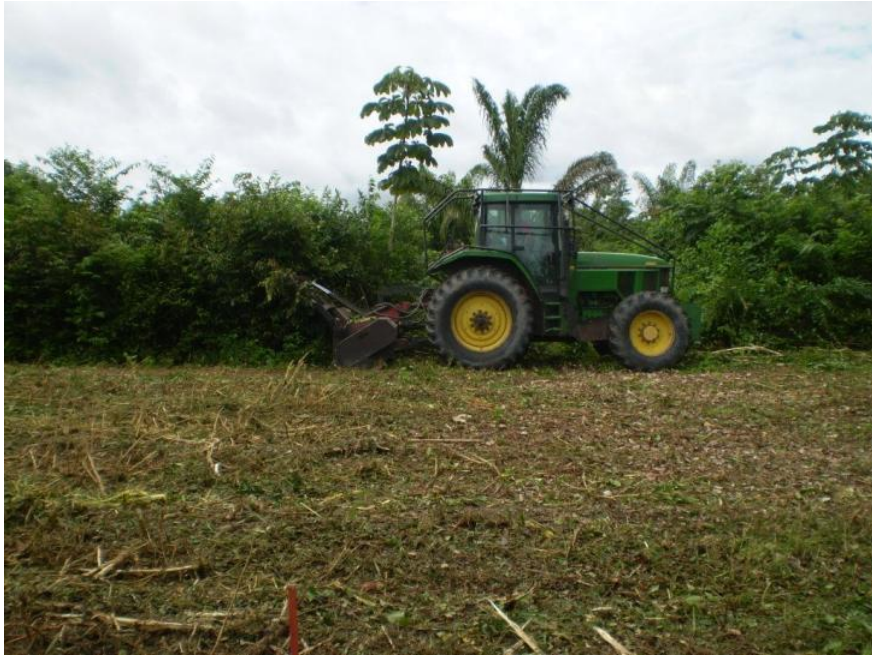
Figura 3 - Trator com triturador de capoeira AHWI FM 600 realizando a trituração da biomassa na área experimental.
