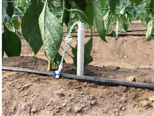
Figura 16. Extratores de solução instalados no solo
