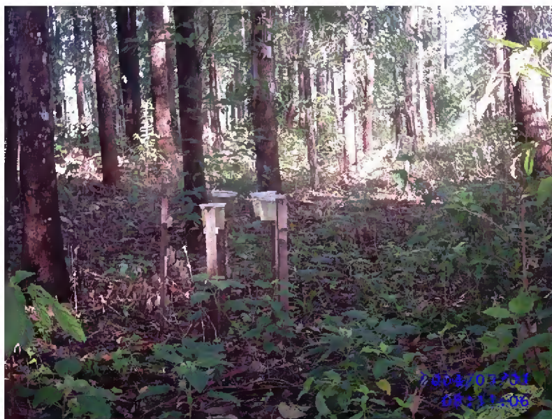
Figura 9 – Sistema de coleta de água de chuva.
