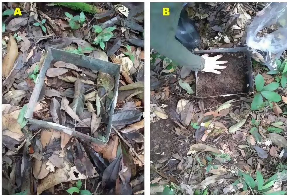
Figura 3-Coleta da liteira estocada com auxílio de gabarito vazado de 0,25 x 0,25 m. Fonte: Autora.
