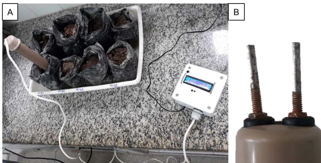
Figura 1. A) Sensor de salinidade em teste no solo. B) Probe que faz a medida da condutividade no solo (é equivalente ao resistor R2 da figura 2).
