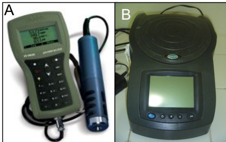
Figura 1.4 - (A) Sonda da marca Hanna; (B) equipamento da marca Hach (DR 2500) para a medição de material em suspensão.
