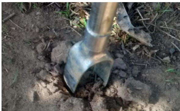
Figura 6. Amostra de solo sendo coletada com trado tipo “holandês”.
