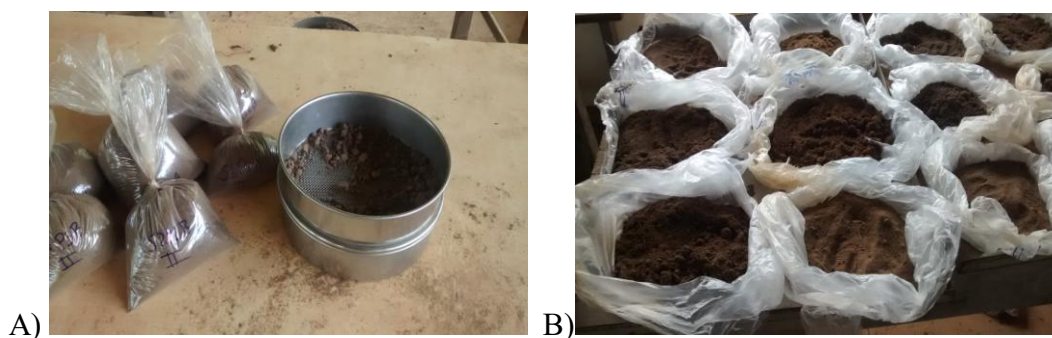
Figura 7. A: Amostra de solo sendo passada em peneira 2 mm. B: amostras sendo secas ao ar.
