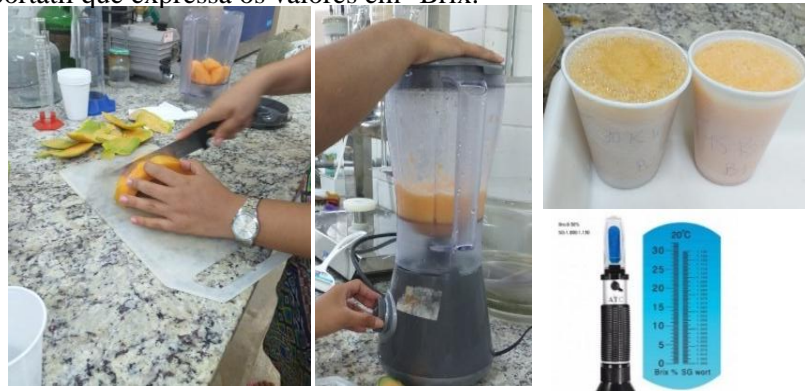
Figura 15- Determinação do teor de sólidos solúvel total (SST), no fruto do meloeiro, com refratômetro portátil que expressa os valores em °Brix.
