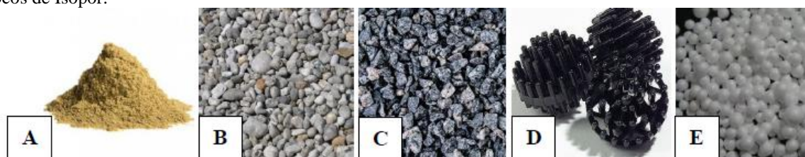
Figura 6 -Tipos de Substrato para filtro biológico: A) Areia Grossa; B) Cascalho; C) Brita; D) Esfera Plástica; E) Flocos de Isopor.
