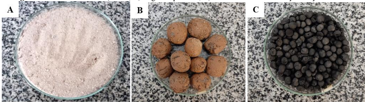
Figure 2- Mídias filtrantes: A)Areia; B) Argila expandida; C) Carvão ativado do caroço do açaí – CACA.
