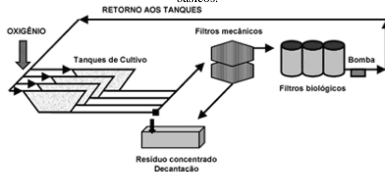
Figura 1- Esquematização de um sistema de Recirculação de Água (SRA) destacando seus componentes básicos.
