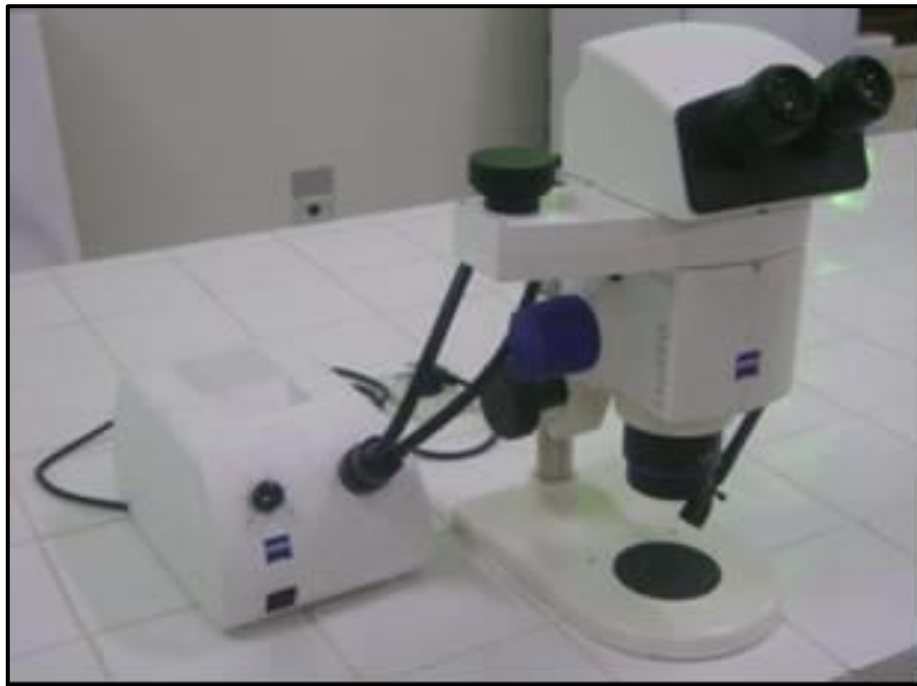
Figura 4: Microscópio estereoscópico utilizado na identificação das larvas.
