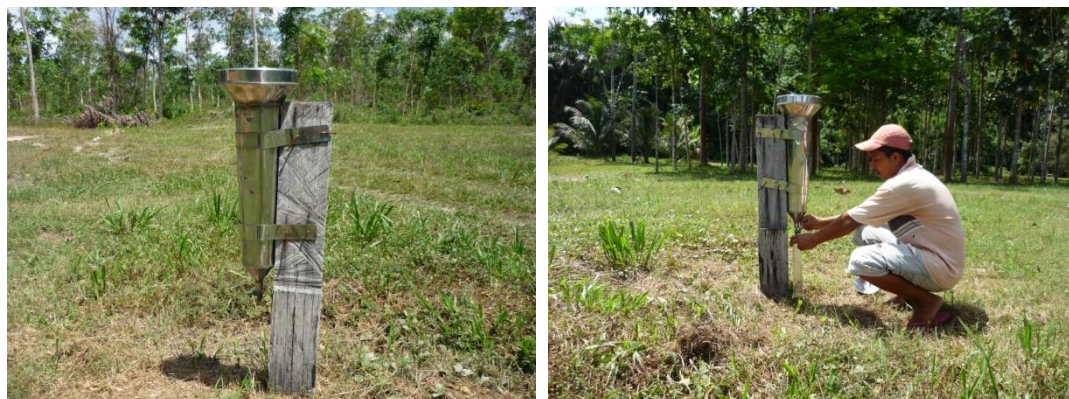
Figura 2: Pluviômetro instalado na Fazenda Tramontina no município de Aurora do Pará, Pará.
