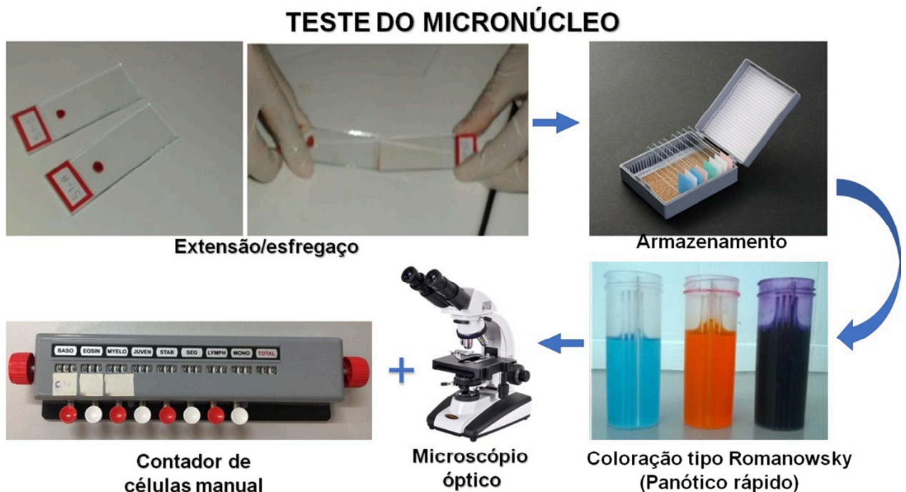
Figura 26 - Etapas para análise do teste de micronúcleo.
