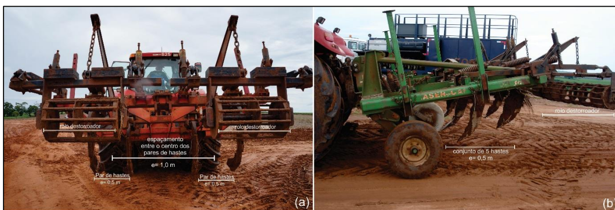
Figura 4. Escarificadores utilizados no preparo mínimo do solo. (a) – escarificador utilizado na escarificação na linha de plantio; e (b) – escarificador utilizado na escarificação em área total.
