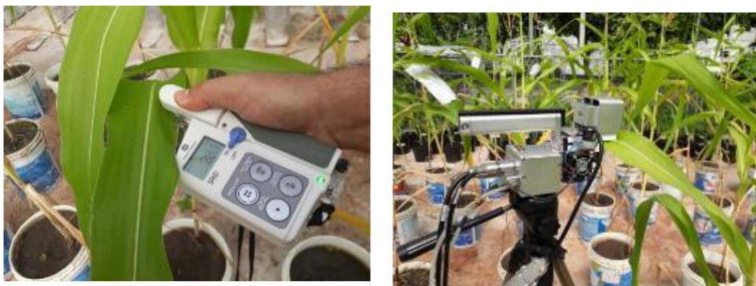
Medição de teor de clorofila através do índice SPAD-502 (Minolta) e trocas gasosas (IRGA, LI-COR 6400-XT, Lincon, USA)
