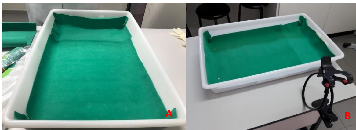
Figura 6 – Campo aberto forrado com EVA (A) e suporte (B) para aplicação do Teste BBB. Fonte: Arquivo Pessoal, 2018.
