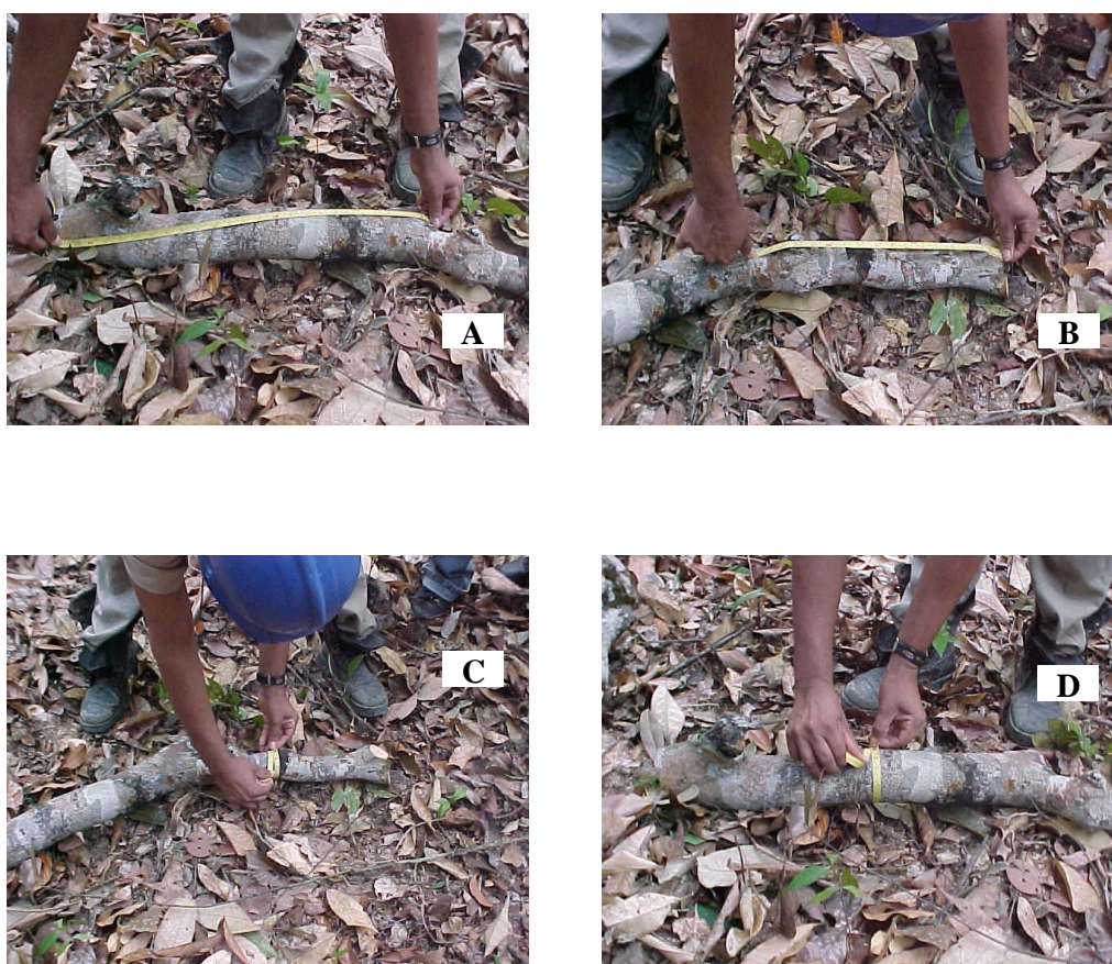
Figura 10 – Medições de comprimento (A e B) e diâmetro (C e D) dos resíduos irregulares.
