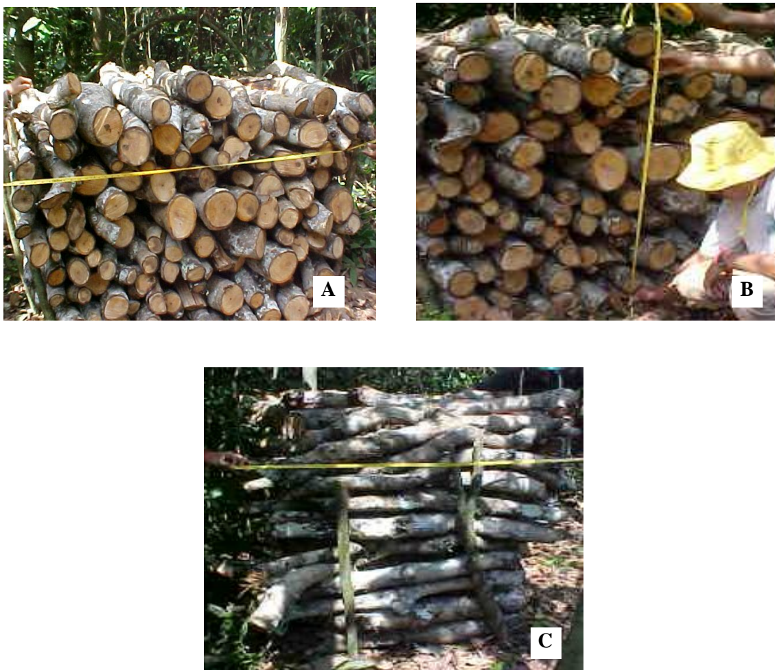
Figura 11 – Medição do comprimento (A), da Altura (B) e da largura da pilha (C).
