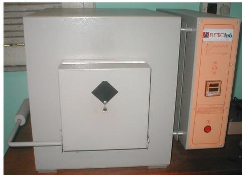
FIGURA 8: Forno mufla para volatilização do biocombustível para análise de material volátil e teor de cinzas.
