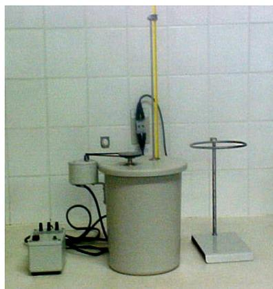
FIGURA 9 Bomba calorimétrica para determinação de poder calorífico.
