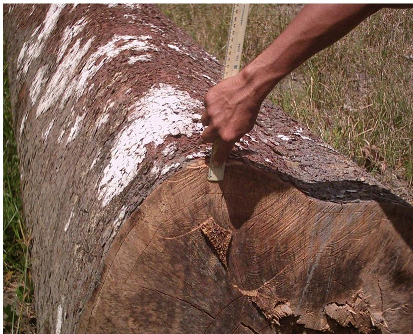
Figura 7 – Determinação da espessura de casca na extremidade da tora com a utilização de uma régua milimetrada.
