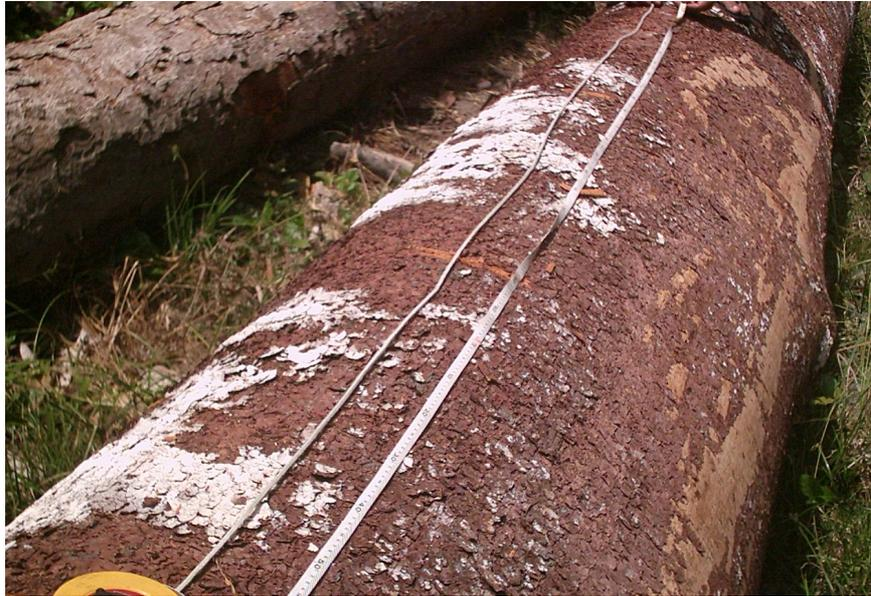
Figura 12 – Medição do comprimento da circunferência com a fita métrica após a tomada da mesma com auxílio do fio.
