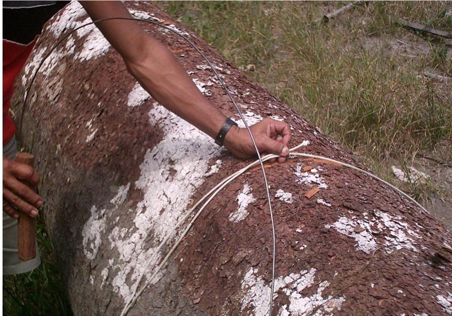
Figura 9 – A medição da circunferência em um ponto de medição previamente determinado ao longo do fuste, com auxílio do fio, fixado na ponta de um arame com cabo de madeira.
