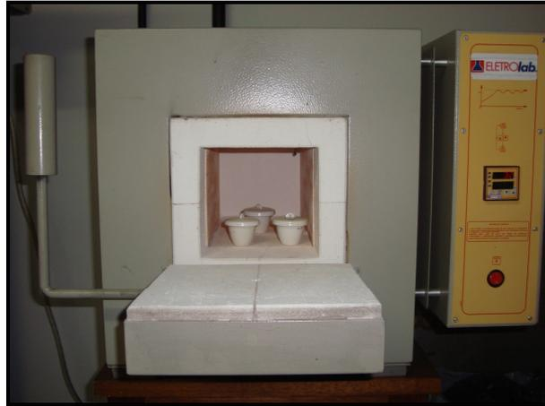
Figura 9. Forno mufla utilizado nas análises de teores de materiais voláteis e teor de cinzas, Laboratório de Tecnologia de Produtos Florestais da UFRA, Belém, PA.
