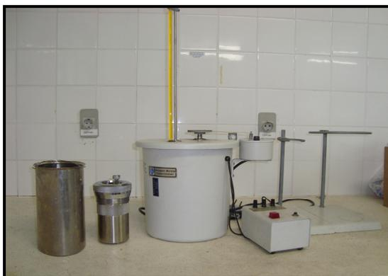
Figura 8. Bomba calorimétrica utilizada na determinação do poder calorífico superior do carvão vegetal, Laboratório de Tecnologia de Produtos Florestais da UFRA, Belém, PA.
