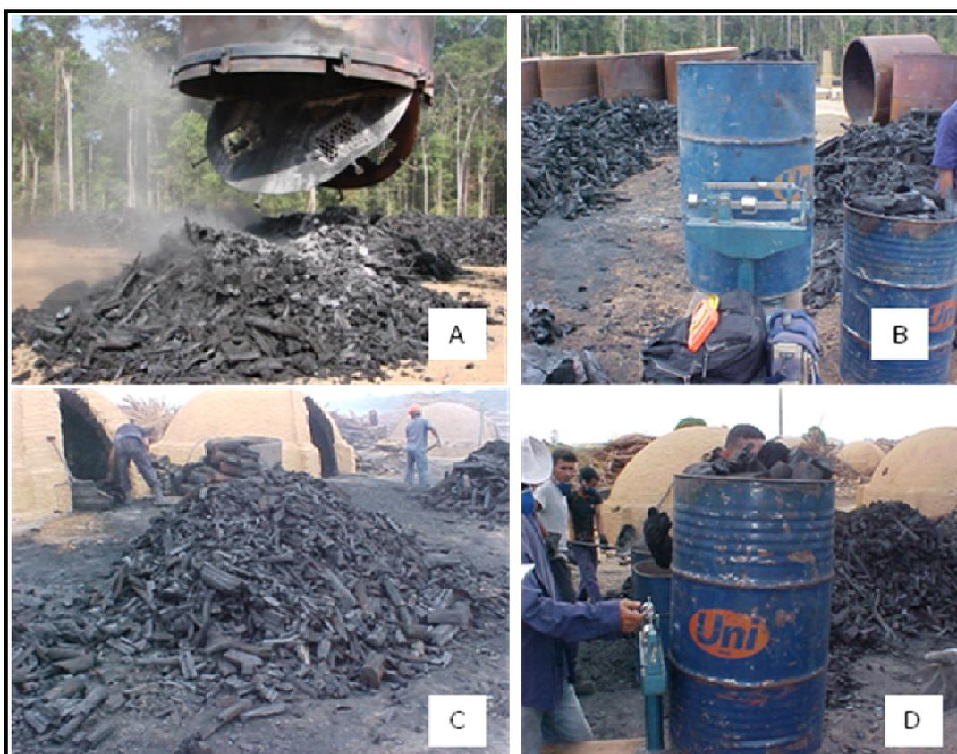
Figura 5. Descarregamento do carvão produzido pelos fornos de carbonização metálico (A) e Rabo Quente (C). Pesagem dos balaio utilizados para medição do volume total a granel do carvão produzido no forno metálico (B) e forno de alvenaria (D). Fazenda Rio Capim, Paragominas, PA.
