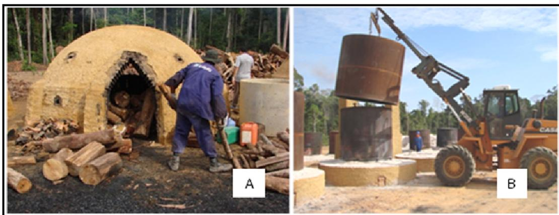
Figura 2. Carbonização de resíduos em forno de alvenaria ou rabo quente (A) e forno metálico (B). Fazenda Rio Capim, Paragominas, PA.
