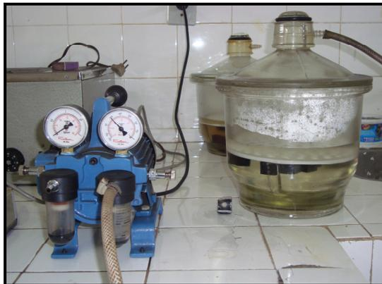
Figura 7. Dessecador acoplado a uma bomba a vácuo utilizado para saturação dos corpos de prova utilizado para determinação da densidade básica do carvão, Laboratório de Tecnologia de Produtos Florestais da UFRA, Belém, PA.
