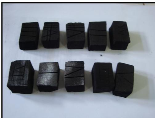
Figura 6. Corpos de prova para determinação da densidade básica do carvão de resíduos de exploração florestal, oriundos da Fazenda Rio Capim, Paragominas, PA.
