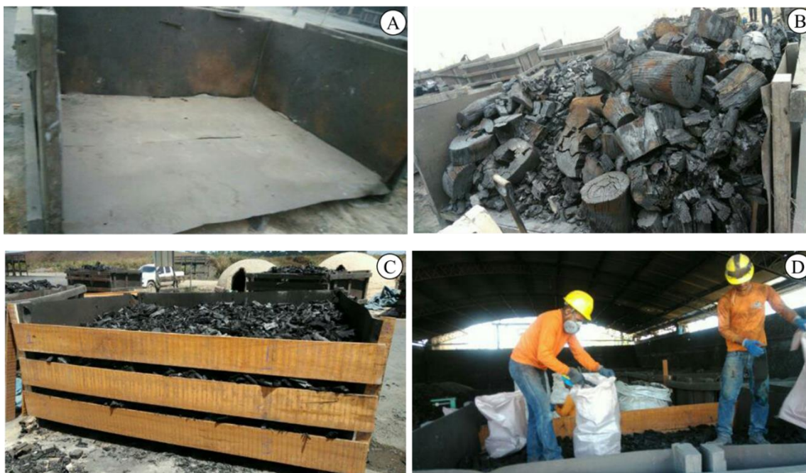
Figura 11 - Metodologia de amostragem do carvão – Caixa metálica vazia adotada na amostragem (A); Caixa metálica com todo o carvão vegetal produzido em um forno (B); Tábuas apregoadas na região frontal da caixa (C); e Amostragem do carvão na caixa metálica de forma aleatória.
