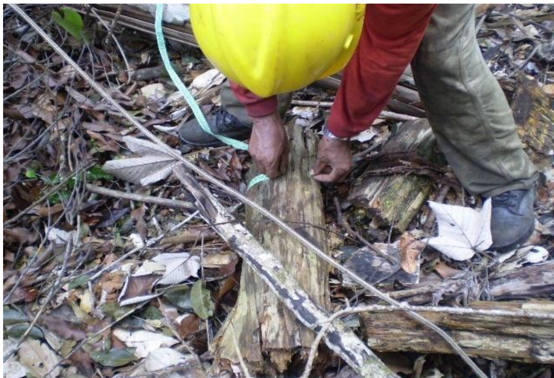
Figura 17 – Medição do diâmetro da peça (resíduo).
