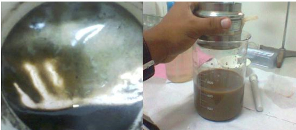
Figura 10- Peneira de aço-inox com malha de 63 \mu\text{m} utilizada no peneiramento das amostras de sedimentos.
