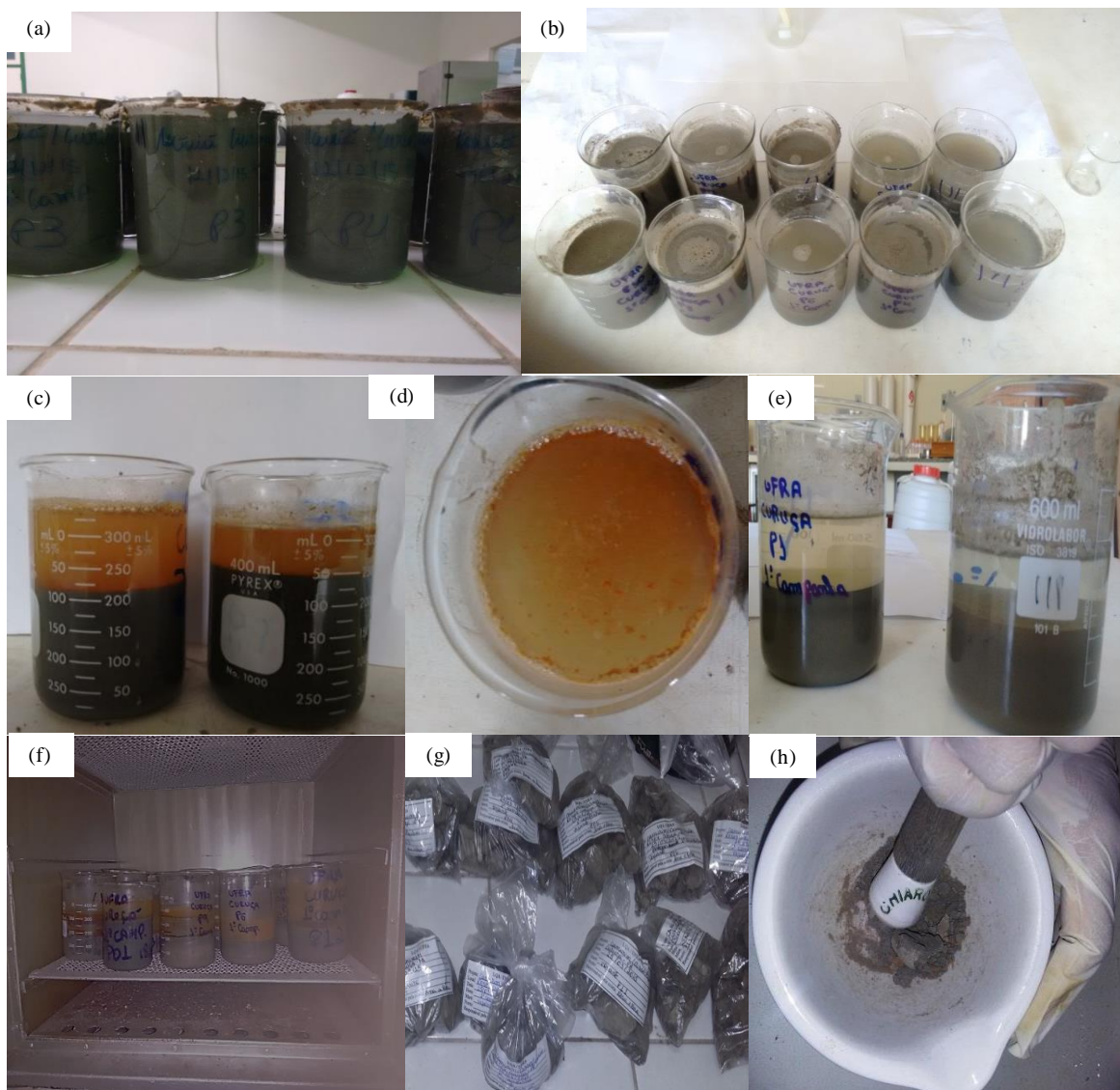
Figura 6 - (a) e (b) processo de lavagem do sedimento; (c), (d) e (e) decantação das partículas; (f) secagem das amostras em estufa; (g) armazenamento das amostras; (h) quarteamento e maceração do sedimento seco.
