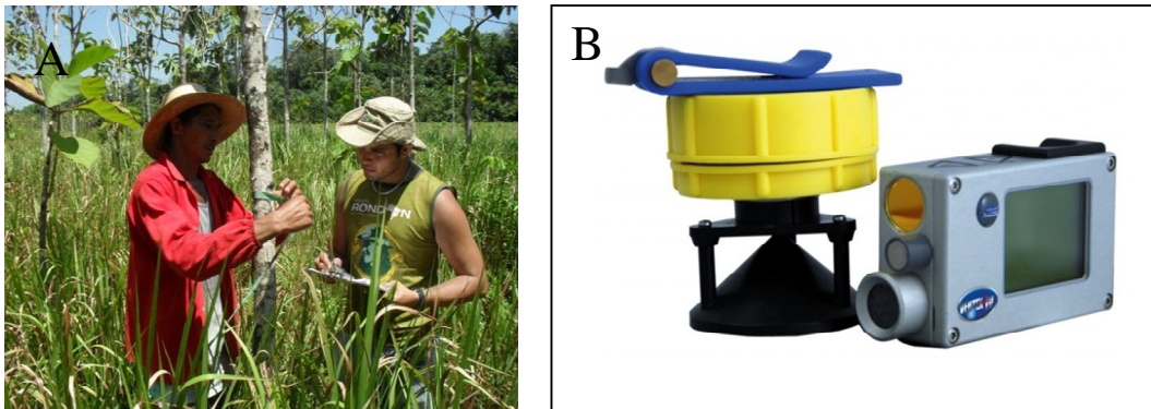
Figura 10 - Instrumentos utilizados para o levantamento dendrométrico: A – Coleta do Diâmetro a altura do peito (DAP) com fita diamétrica B – Hipsômetro Vertex utilizado para medição da altura total.
