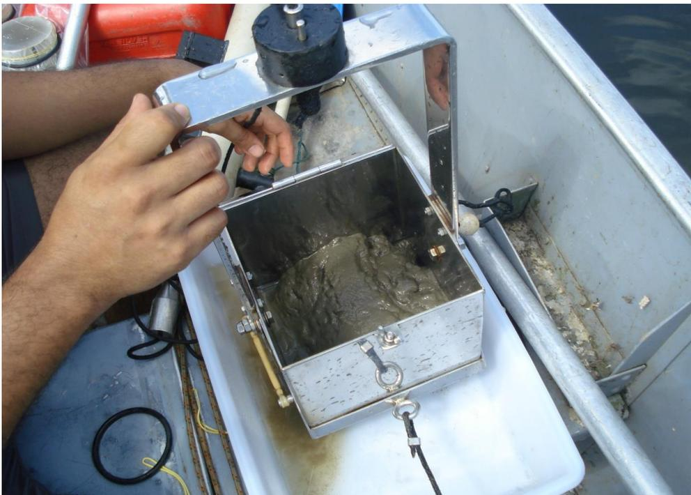
Figura 5. Draga de Ekman utilizada na coleta de sedimento de fundo.
