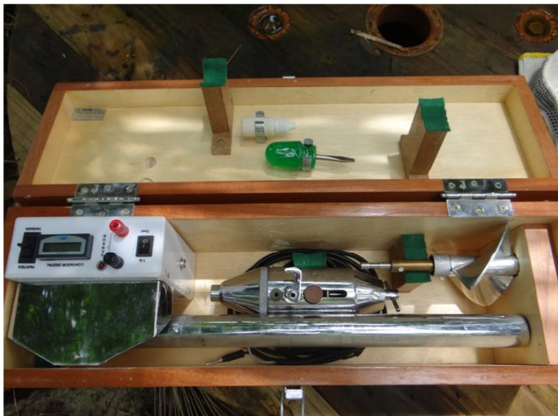
Figura 5: Molinete Fluviométrico, modelo MLN – 7.
