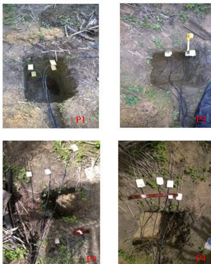
Figura 03: Demonstração dos perfis abertos antes da instalação dos sensores.
