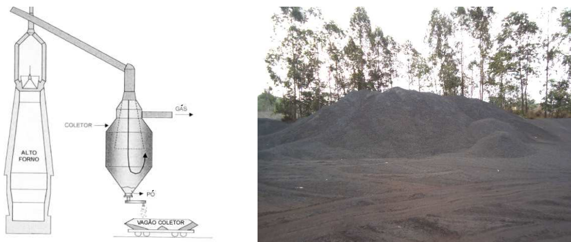
Figura 1 - Esquema de alto forno e coletor de pó de balão (Fonte: OLIVEIRA e MARTINS, 2003) e Resíduo “pó de balão” no pátio da siderurgia (Fonte: SINOBRAS - Siderúrgica Norte Brasil S.A.).
