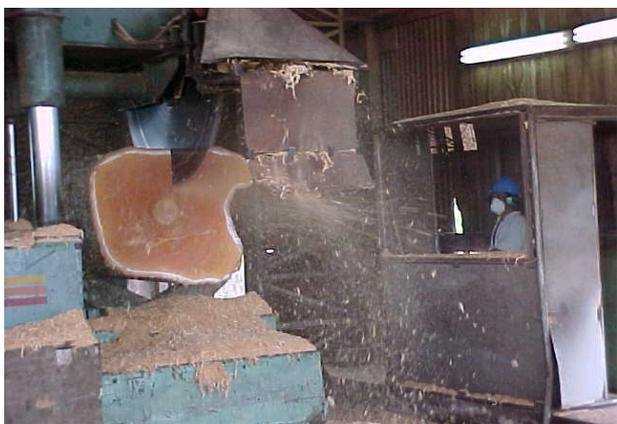
Figura 44. Resíduos gerados durante o corte dos blocos (serragem)
