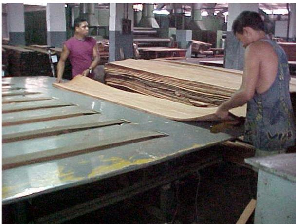
Figura 39. Lotes de lâminas de madeira a serem guilhotinadas após a secagem
