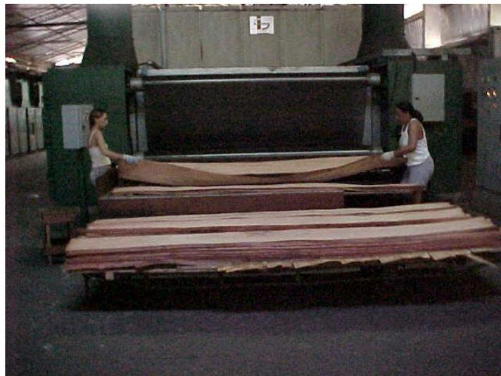
Figura 37. Lâminas de madeira saindo da secadora
