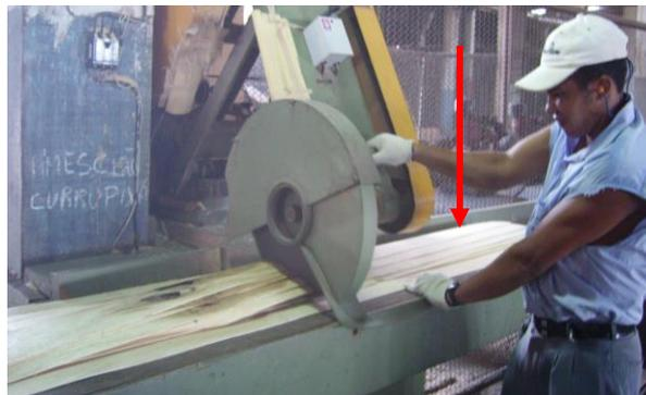
Figura – 28. Aproveitamento de lâminas impróprias oriundas da guilhotina grande para produção de lâminas transversais para compensado.
