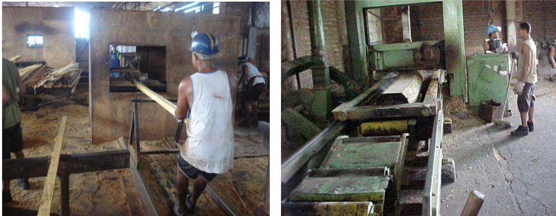
Figura 67. Maquinários em precárias condições de funcionamento e sem nenhuma regulagem e manutenção
