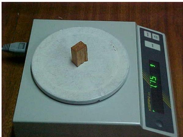
Figura 43 (A). Determinação do peso da amostra de madeira
