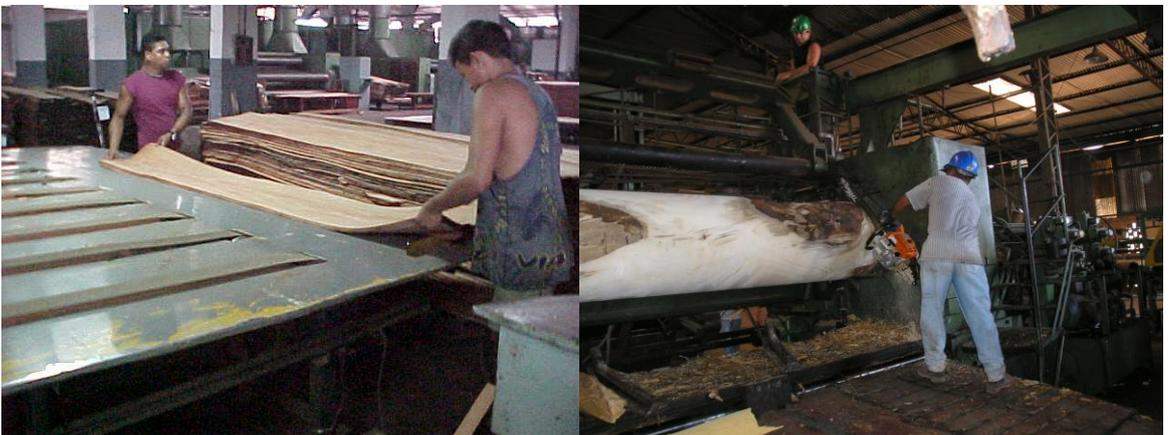
Figura 70. Funcionários sem nenhum treinamento, subindo no equipamento, usando equipamento indevido para essa operação, sem uniforme adequado e sem usos de EPIs.
