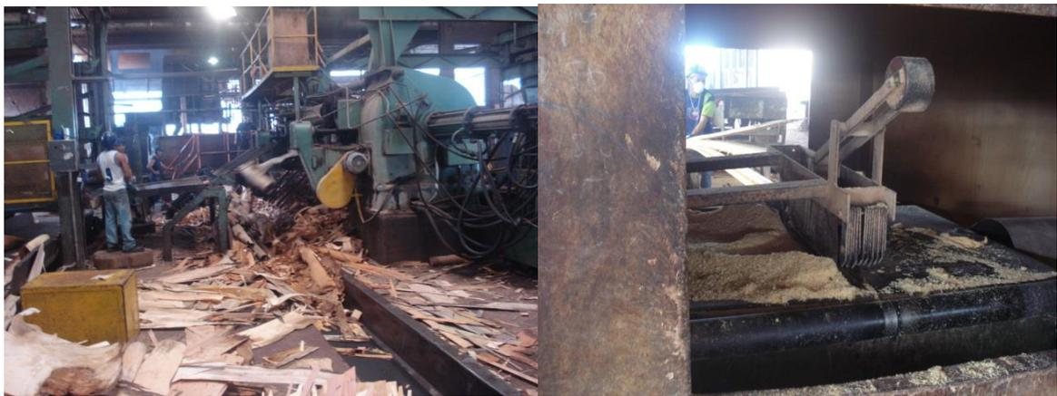
Figura 68. Maquinários em precárias condições de funcionamento e sem nenhuma regulagem e manutenção
