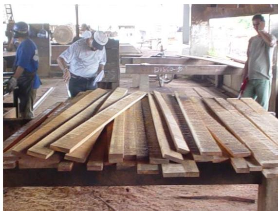
Figura 07. Serrados obtidos no Corte 2, em multi-serra.
