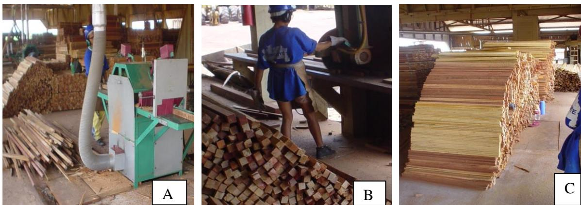
Figura 23. Esquadrejadeira (A) para produção de sarrafos, Destopadeira (B) para padronização de comprimento de sarrafos e Lote de sarrafos (C).
