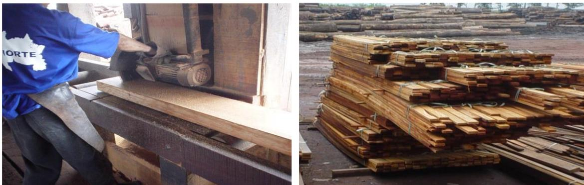
Figura 13. Corte em destopadeira para padronização do comprimento da peça. Figura 14. Lotes de serrados de diferentes comprimentos.
