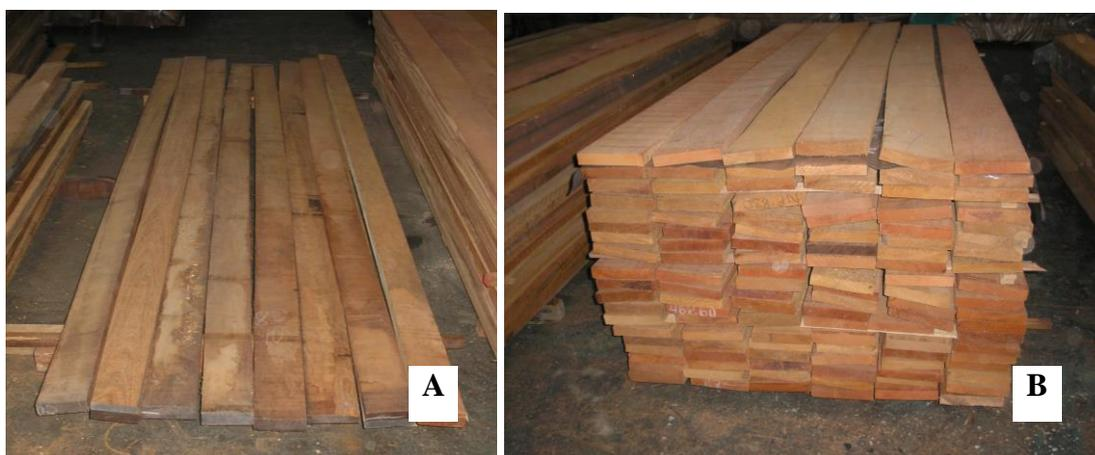
Figura 57. Peças de serrado bruto, empenadas devido à secagem em estufa.
