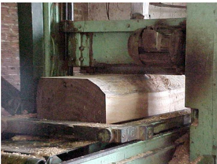
Figura 35. Filé pronto com face plana para faqueamento.
