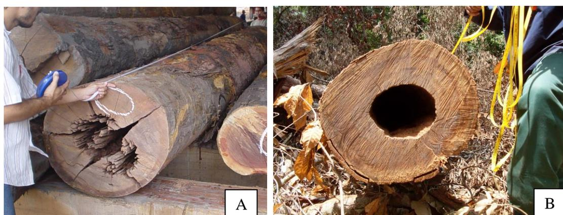
Figura 64. Sanidade das toras – toras podres e rachadas (A) e toras ocadas (B)
