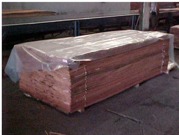
Figura 42. Feixes de lâminas de cada tora, embalados em lona plástica
