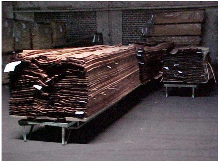
Figura 38. Feixes de lâminas de madeira após a secagem
