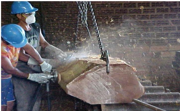
Figura 34. Raspagem para retirada de manchas dos filés
