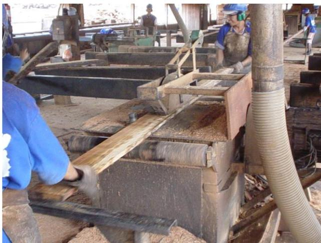
Figura 09. Reaproveitamento de resíduos oriundos do Corte 2, em serra circular.
