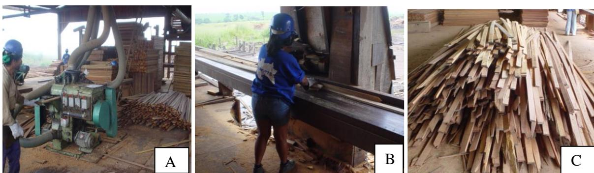
Figura 22. Ripeira (A) para produção de ripas e Destopadeira (B) para padronização de comprimento de ripas e Lote de ripas (C)
