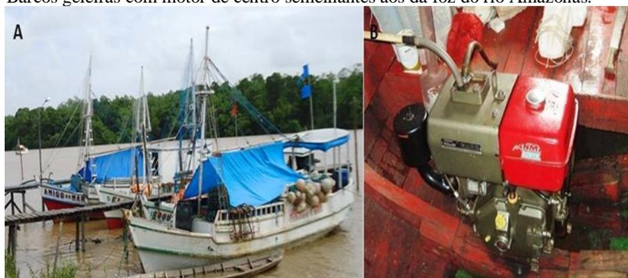
A) Barcos de pequeno porte (BPP), utilizados na região litorânea e costeira do Amapá e B) Motor de centro a diesel utilizado como propulsão dos BPP.
