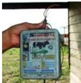
Figura 14. Eletrificador rural para cerca elétrica em área de várzea (QUINZEIRO NETO, 2010).
