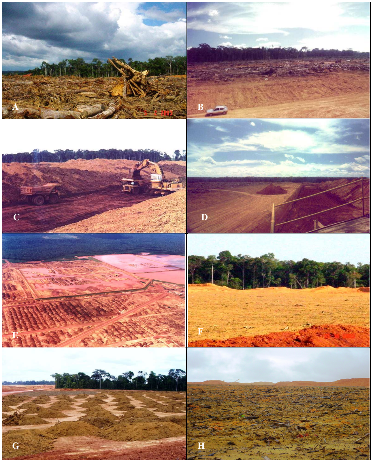
Figura 3. (A) Desmatamento: corte raso da floresta; (B) decapeamento (1º plano), desmatamento e floresta; (C) extração e transporte da bauxita; (D) extração da bauxita em faixas; (E) pós-lavra em faixas da bauxita, essas áreas é que deverão ser restauradas anualmente; (F) área sistematizada pelo trator de esteira; (G) adição de terra preta na área sistematizada para espalhamento superficial; (H) área pronta para o plantio florestal c.a. 80 espécies; FLONA de Saracá Taquera, Porto Trombetas, Oriximiná, Pará.
