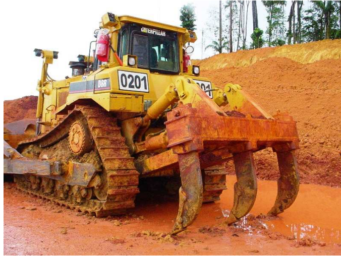
Figura 5. Trator de esteira D-8 com um ripper de três garras que atingem 1m de profundidade acoplado na tomada de força; Flona de Saracá Taquera, Porto Trombetas, Pará.
