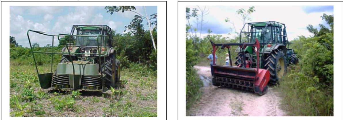
Figura 1. Tritucap à esquerda e fresadora AHWI (à direita) ambos acoplados a um trator
