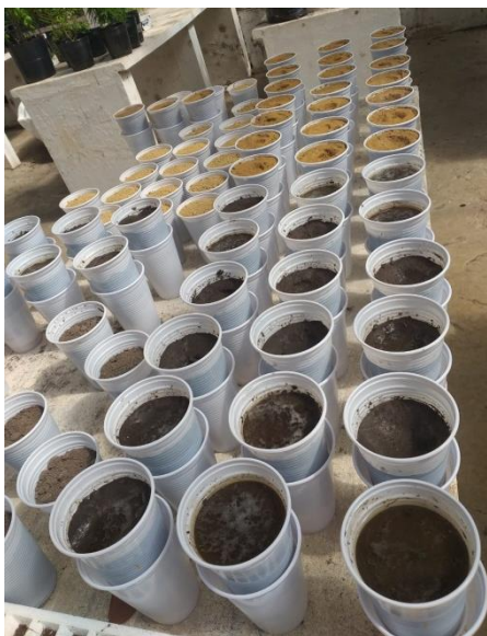
Figura 9. Teste de lixiviação de N em colunas conduzido em casa de vegetação.
