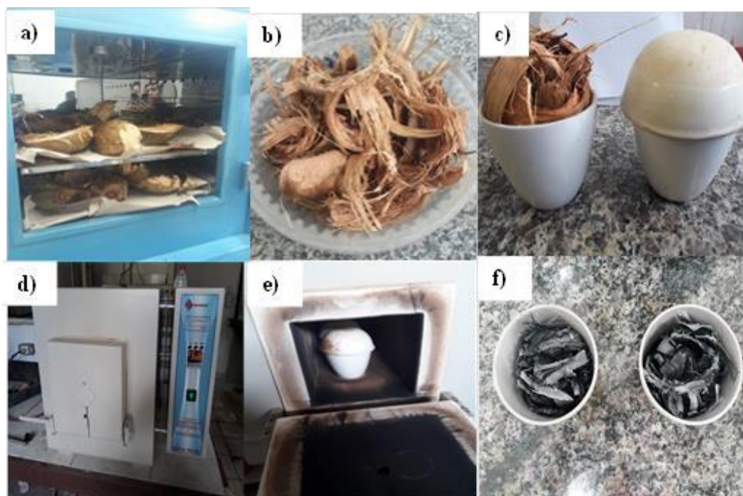
Figura 3. Secagem da biomassa em estufa (a); resíduos de coco fragmentados após secagem (b); materiais acondicionados em cadinhos de porcelana (c); tipo de forno utilizado para a produção dos biocarvões (d); cadinhos com materiais antes da pirólise (e); produto final da pirólise de resíduos de coco em temperatura de 400 °C (f).
